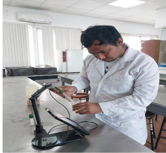
Determinación de pH y Conductividad Eléctrica en Drenaje Acido de Mina.
