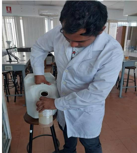
Toma de muestra del Drenaje Acido de Mina para la prueba de Jarras.
