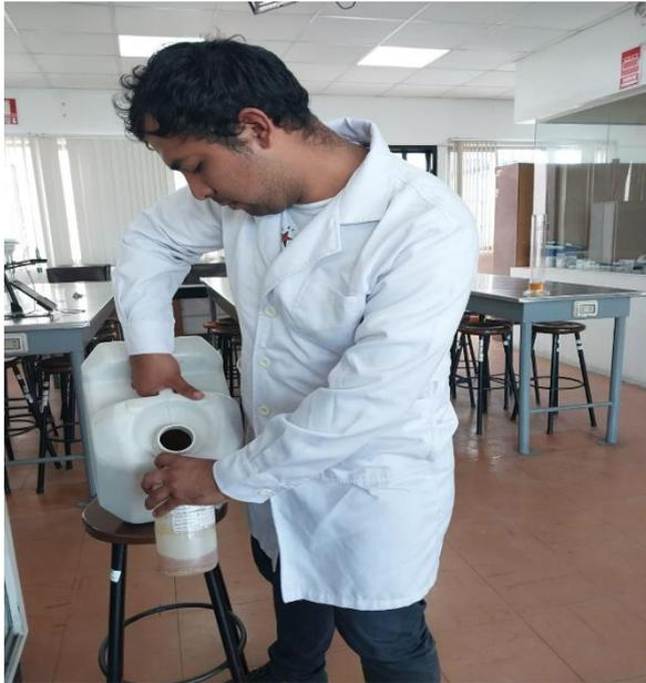
Toma de muestra del Drenaje Acido de Mina para la prueba de Jarras.
