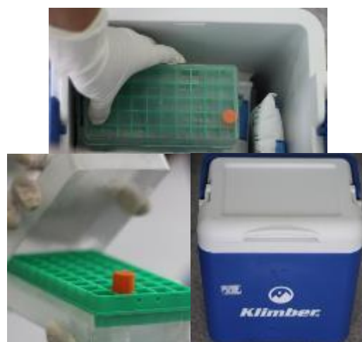
Imagen 53: Colocación del criovial en un cooler para conservar la muestra en una temperatura estable para posterior transporte al laboratorio.
