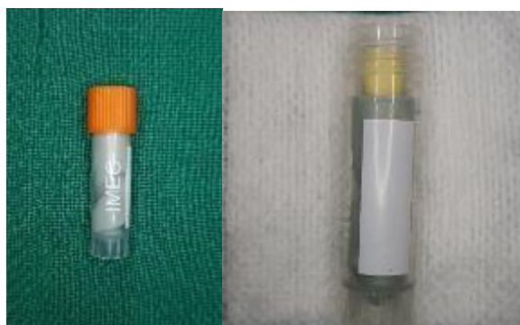
Imagem 23: Raiz fixada em bloco de sílica e colocada verticalmente em um tubo criovial.
