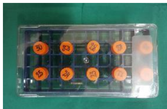
Imagem 24: Colocação da amostra em uma caixa autoclavável para sua posterior esterilização.
