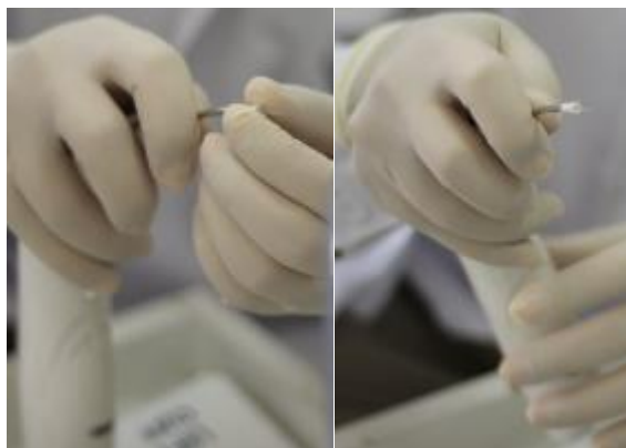
Imagen 48: Instalación de un Tip de 200 \mu\text{m} de diámetro en la punta del equipo láser para posterior irradiación.
