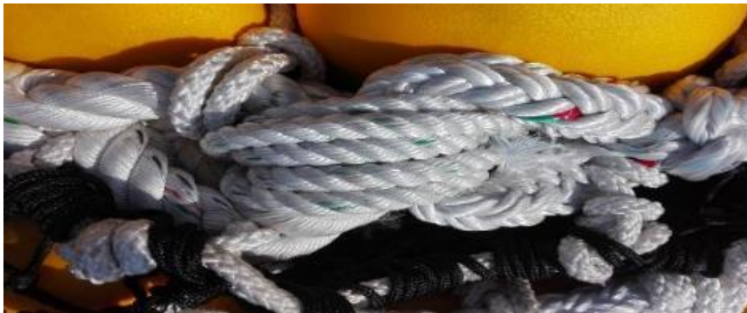
Figura 30. Unión del Cabo Tc 1 3/4" y Cabo Tz 1 1/2".
