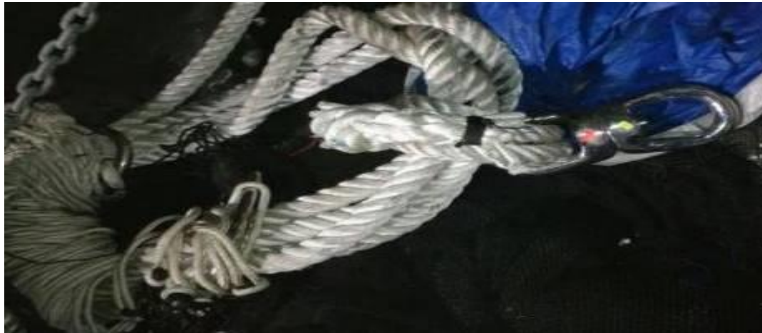
Figura 34. Unión de la cuba con el ocho giratorio de 1 ¼”.
