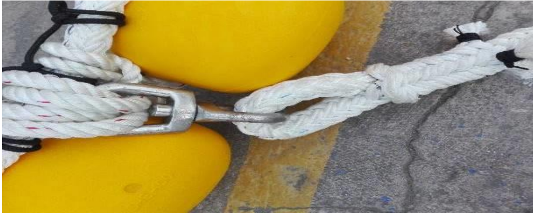
Figura 28. Unión del 8 giratorio de 1" con la Relinga Superior.
