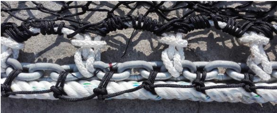
Figura 17. Encabalgue y unión de cadena con cabo de respeto.
