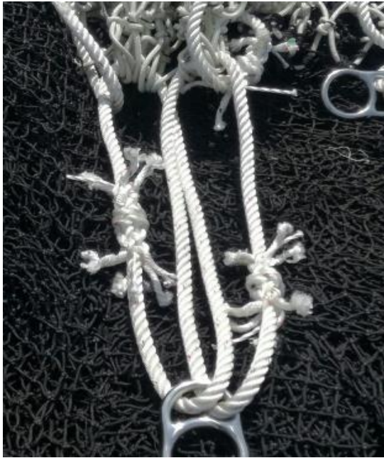
Figura 7. Estrobos con su anilla Tipo estribo de 4" x 3/4" de la red atunera Bamar I.
