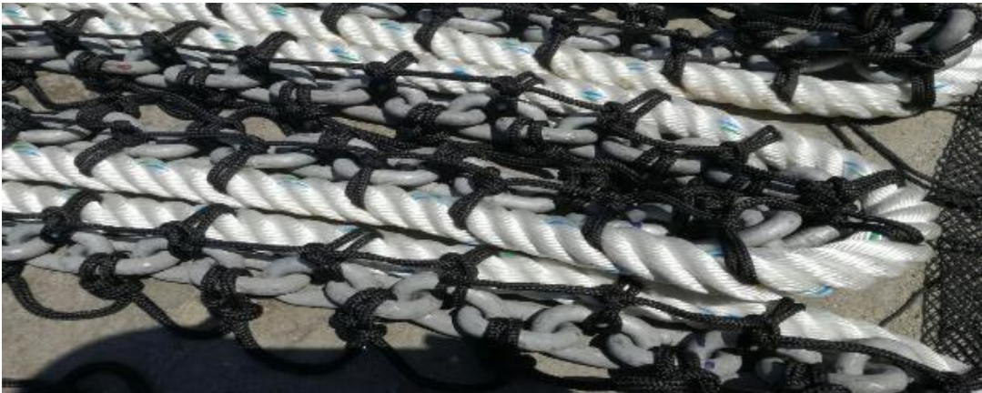
Figura 29. Encabalgue de la cadena \frac{9}{16} con cordel USA 300.
