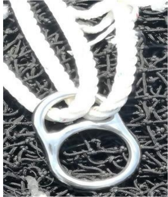
Figura 7. Estrobos con su anilla Tipo estribo de 4" x 3/4" de la red atunera Bamar I.
