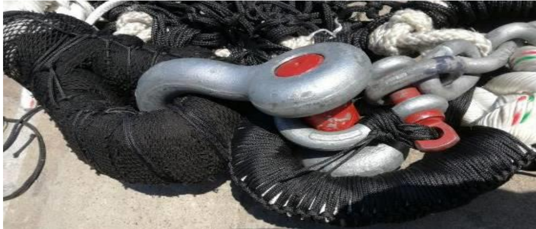
Figura 10. Unión de Relinga superior (cadena 5/8" con cabo mixto 1 3/4").
