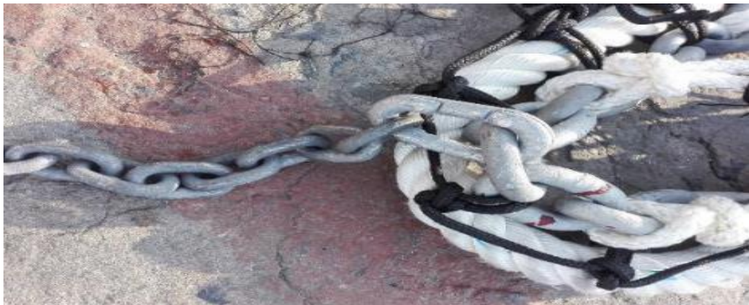
Figura 27. Unión de la pata con la Relinga Inferior.
