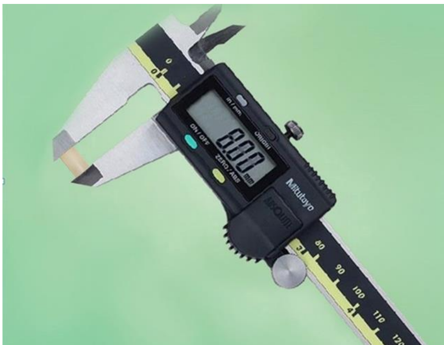
Medición de altura de la probeta de resina.
