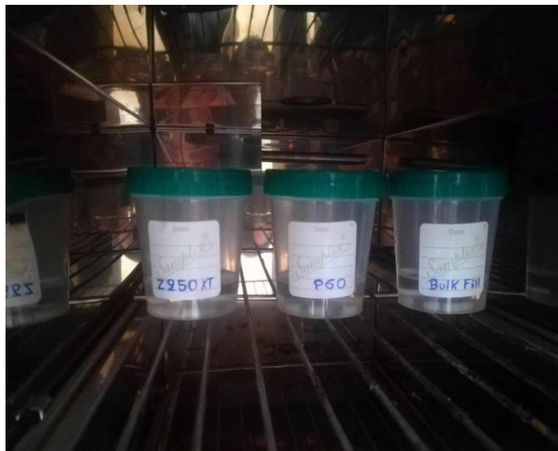
Envases (probetas y agua destilada) dentro de estufa (37°C x 24hrs).
