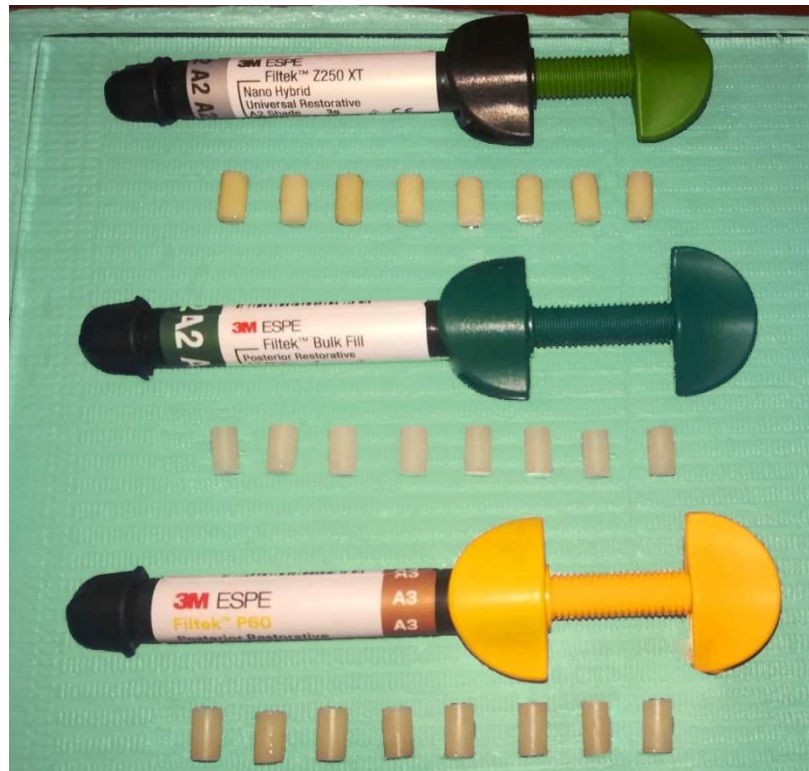
Probetas cilíndricas de 4 x 8 mm.
