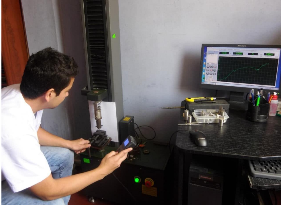
Máquina para ensayo de resistencia compresiva – Lab. HTL
