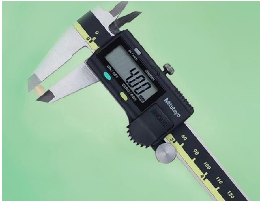
Medición del diámetro de la probeta de resina.
