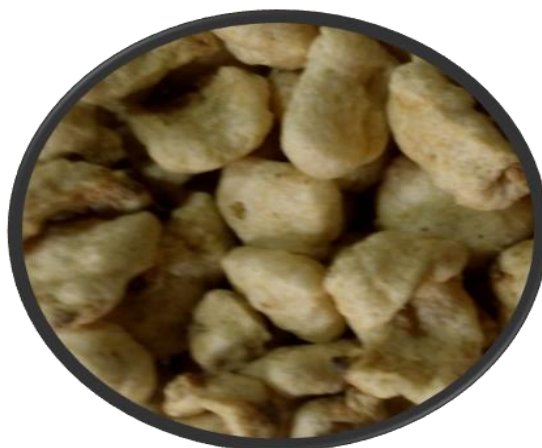
Figura 11. Kiwicha formado (expandido) después de la salida del extrusor.
